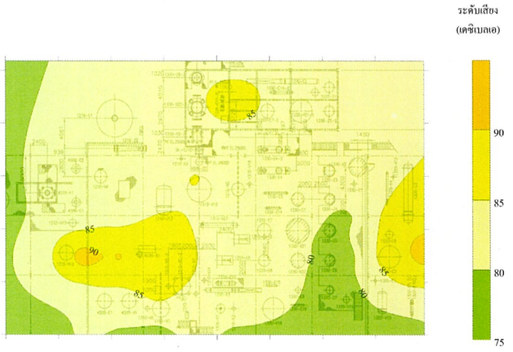
รูปที่ 89 แผนผังแสดงระดับเสียง (Noise Contour Map) บริเวณ 4 th Floor Area (CPL Plant) โครงการโรงงานผลิตকাপ্রলেটন บริษัท গুণে তেক্সটাইল (এজি) জাকট (মহান)
